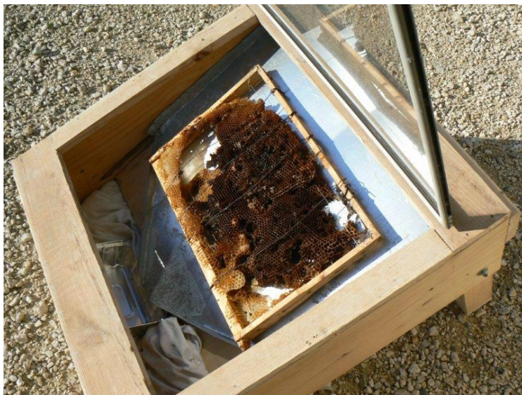
Figure 12 : Cérificateur solaire contenant un cadre de cire de corps
