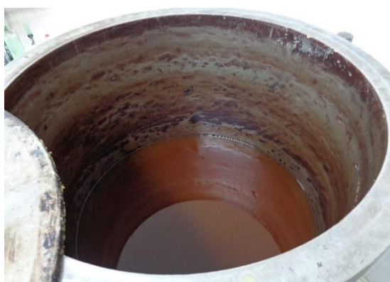
Figure 38 : Cuve de fonte contenant de la cire fondue
