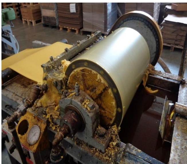
Figure 39 : Laminage de la cire
